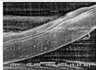
图 5 PVA-SPF 的大分子束在纤维内轴向有序排列的电子显微镜照片
