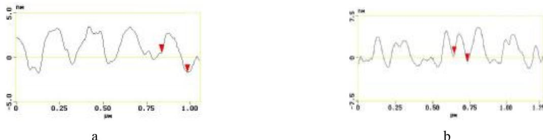
图 5.3 TiO<sub>2</sub> 薄膜表面上由 AFM 观察到的粗糙度截面轮廓曲线（表面处特征方向如图）
