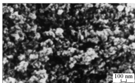
Fig. 3 SEM image of PAS nanoparticles
