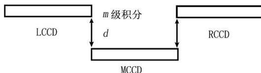
图 1 02B 星 CCD 器件示意图
