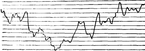
图6 四罗拉偏心弯曲引起的马鞍波
