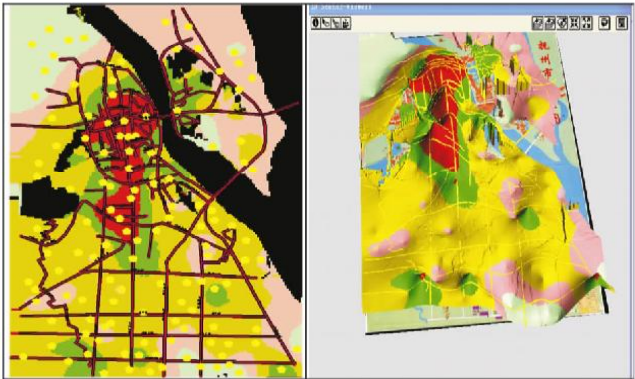
图 5 最优方法克里金指数模型的效果图及 3D 图形
