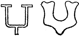
图 1 仿羽绒纤维的喷丝孔形状(左)和纤维断面(右)
