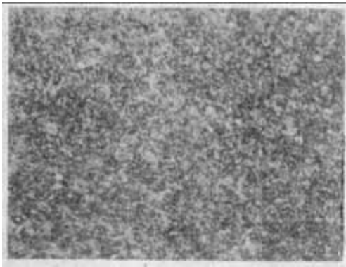
图4 旧钢领经化学抛光后的内跑道表面形貌 (×100)
