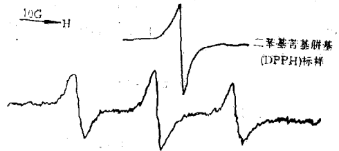
图 4 用捕获剂捕获后 MMA 自由基的 ESR 谱
