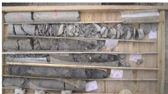
图 2 压水孔挤压带岩芯照片
