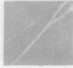
图 2 NaOH 160 克/升处理后亚麻纤维纵向照片 \times 500
