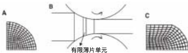
图 4 平辊压扁轧制成型工艺的有限单元片分析法
