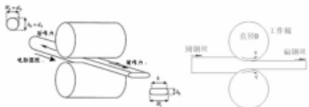
图2 圆钢丝压扁轧制变形示意图
