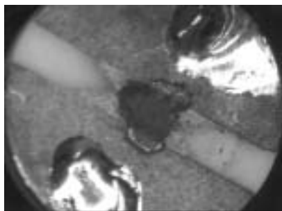
图 6 发火后蝶形金属薄膜桥
