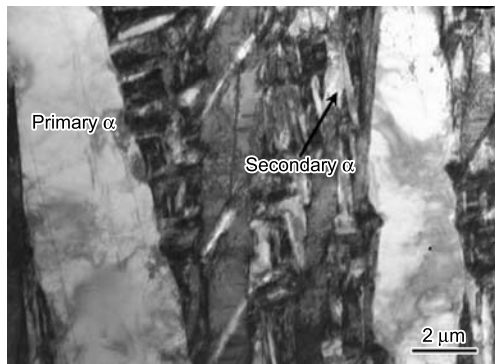
图 4 片层组织 (图 2a) 经过两相区 950 °C 第二重热处理后得到的双片层组织
