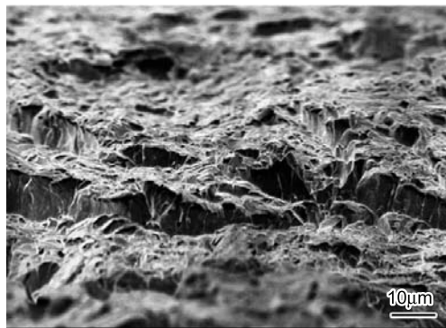
图 6 分层裂纹表面 SEM
