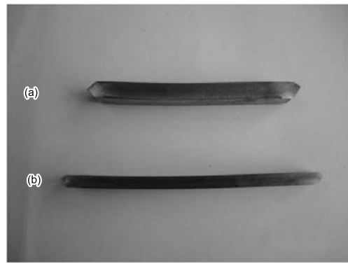
图 1 工业纯钛经室温 ECAP 与冷轧复合变形后试样的宏观形貌
