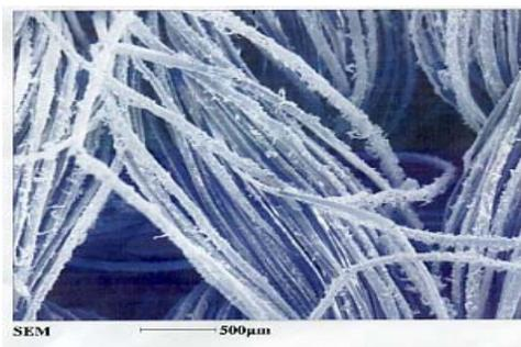
図6 ニット生地上の銅金属皮膜
