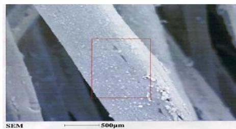
図4 生糸撚糸の銅金属皮膜
