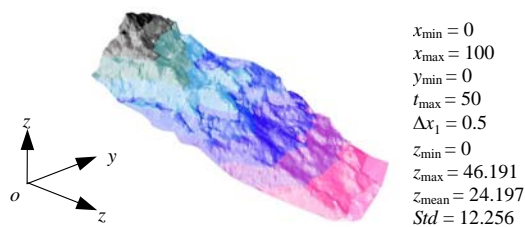
图 2 膏溶角砾岩断口表面的三维视图(单位: mm) Fig.2 3D view for fracture surface in gypsum breccia (unit: mm)
