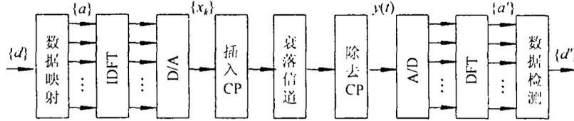
图 1 OFDM 系统原理框图
