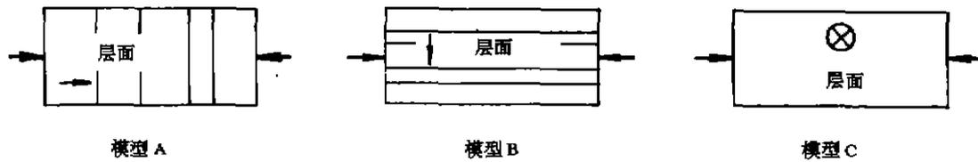
图 1 即时压缩 SEM 试块地质力学模型
