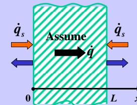
Assume  $\dot{q}$  Heating  $\begin{cases} -k \frac{\partial T(0,t)}{\partial x} = 50 \\ -k \frac{\partial T(L,t)}{\partial x} = -50 \end{cases}$
