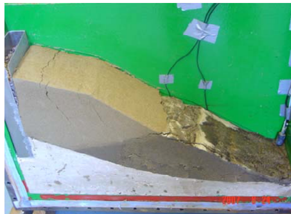
图 11 离心模型试验后的滑面形态
