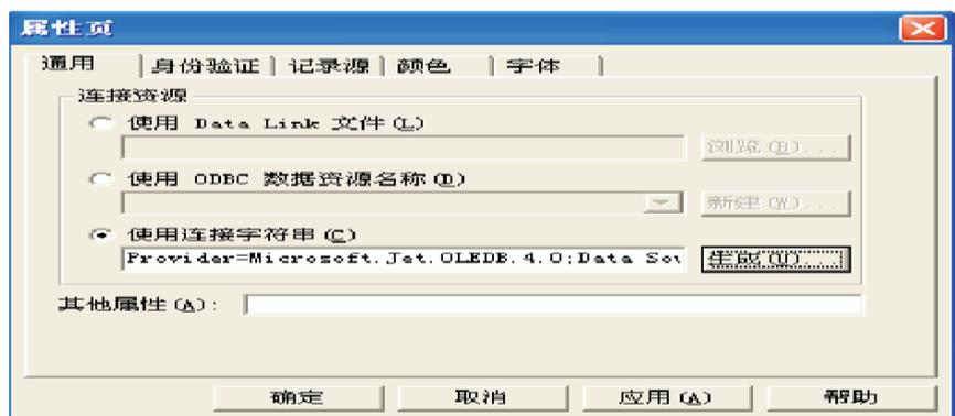
**3.2 使用 ActiveX 数据对象建立它们之间的链接, 实现查询修改功能** 在使用 ActiveX 数据对象建立与数据库链接后, 主要使用 SQL 语句中的“select \* froms ...where ...”实现查询的功能<sup>[2]</sup>。
