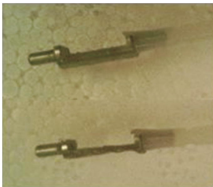
図2 内蔵されている偏心分銅(上:歯ブラシA, 下:歯ブラシB)
