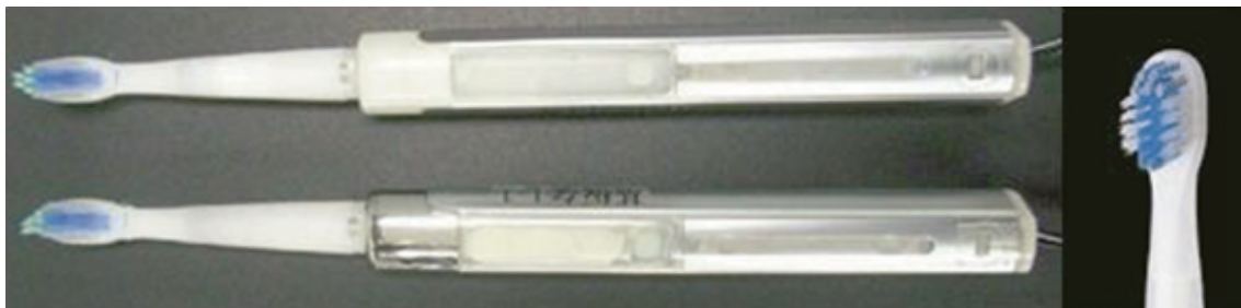
図1 実験に使用した音波式電動歯ブラシ(上:歯ブラシA, 下:歯ブラシB)とブラシ
