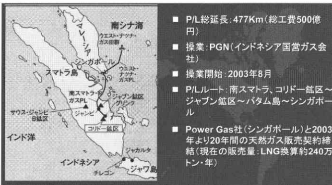
図 33 国際パイプライン②-南スマトラガスパイプライン
