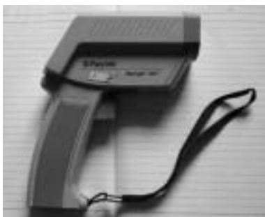
图 2 红外线测温仪 Raynger MX™
