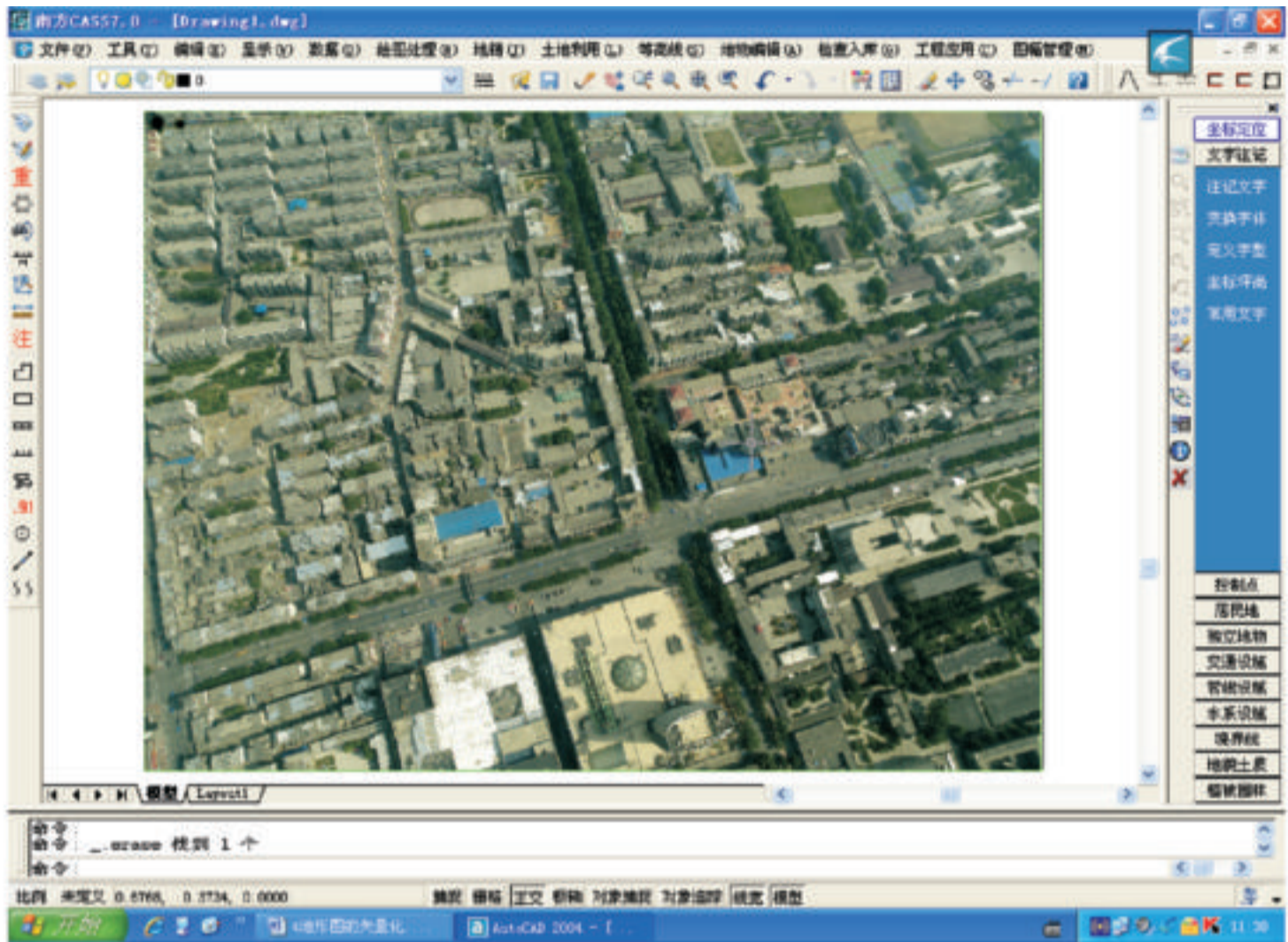
图1 CASS 7.0 的系统纠正光栅图像界面
