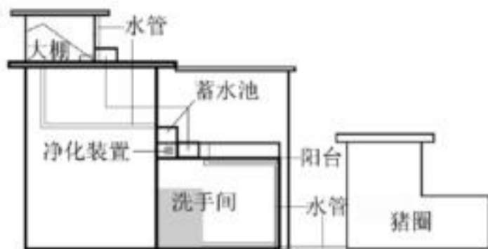
图3 雨水收集及水循环系统图
