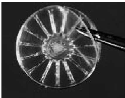
図 1 下流側から見たジェリーフィッシュ弁 Fig. 1 Membrane side of the jellyfish valve.
