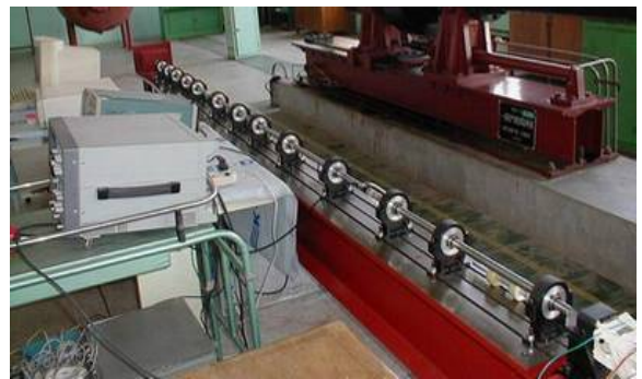
图 1 多杆径通用 Hopkinson 试验平台 Fig.1 Set up of multi-diameter Hopkinson bar
