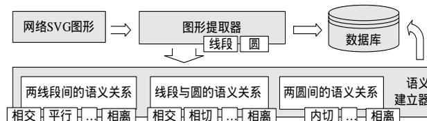
图 2 SVG/VML 解析器构建图形库的框架
