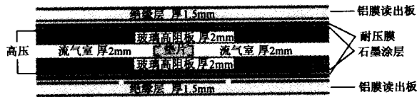
图 1 玻璃 RPC 的结构简图
