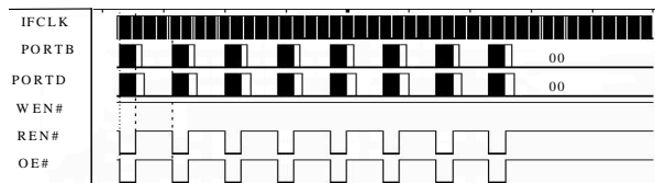
图 6 控制器读时序图
