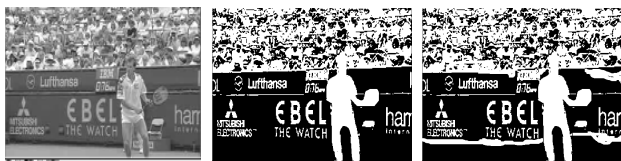
(a)原始图像 (b)使用 J. Konrad 算法后的二值图像 (c)使用二值函数去除噪声点后的二值图像
