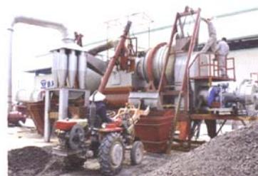
配机，料仓容较大，送料速度快，且可以使用30型装载机或40、50装载机送料，矿料不会混仓，保证级配的准确性。
