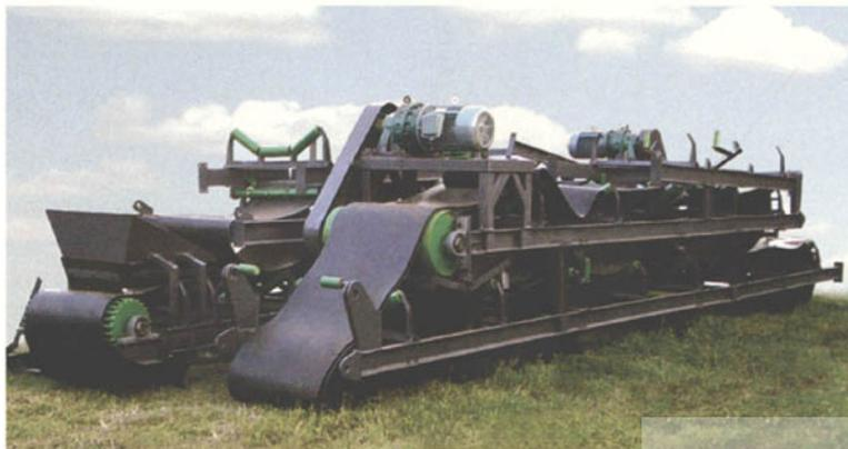
地大小做到“一”字形布置或“L”字形布置，机动灵活性高，场地适应性强。搅拌机轴承座与搅拌缸体脱离，永无污物渗入之忧，确保高度可靠。搅拌缸底部特设清料窗口，便于内部物料清除。搅拌机上无任何障碍物，直观可视且有足够的操作空间，检查、维护方便。
