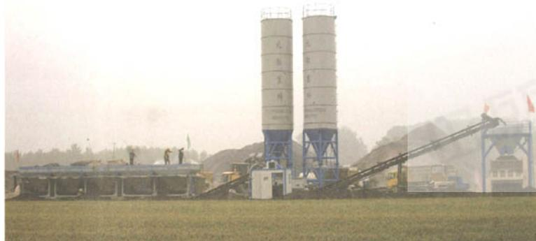
20世纪90年代初至今,北联重科见证了国内稳定土厂拌设备从无到有的整个历程。北联重科具有近20年的稳定土厂拌产品开发、制造、销售及管理等丰富经验。WCD系列稳定土厂拌设备是北联重科专门为修筑高等级公路的稳定层而设计的,采用电子称重的计量方式,尤其适合于水泥稳定土、石灰稳定土及级配砾石的工程
