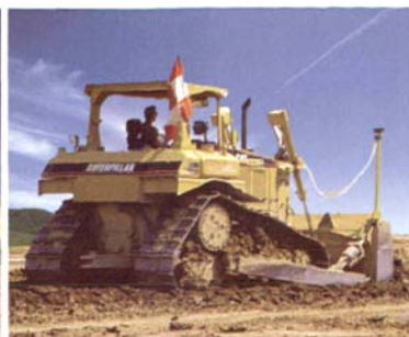
图10 装有GPS自动找平装置的推土机
