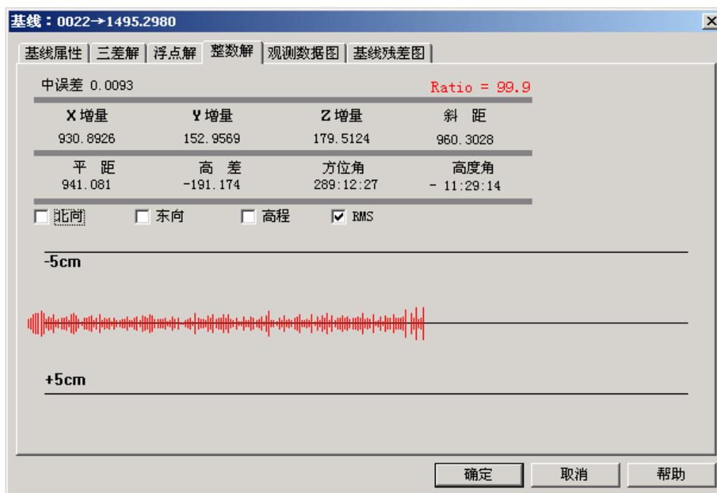
从属性中我们看到GPS基线的平距为 941.081，与全站仪仅相差 0.035 米。有这一点我们就可以判断GPS和全站仪的测量均没有问题<sup>1</sup>。在华测GPS数据处理软件的基线属性中，除列出了基线的斜距外，还列出了基线的平距，这里的平距既非椭圆面上的弦长，也不等同于全站仪的平距，它是根据基线斜距和基线高差通过勾股定理计算出来的。当基线较短时，椭圆面的弦长、全站仪的平距、基线属性中的平距三者之间相差较小，它们通常也具有可比性。
