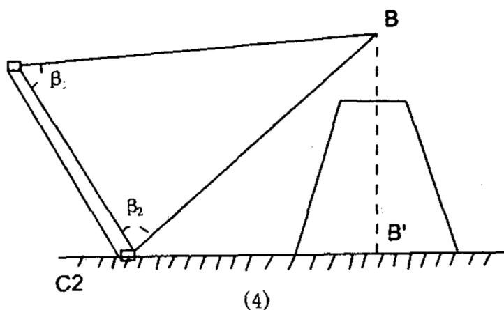
在离建筑物较远处选择一条基线,  $C_1C_2$ ; 测出  $C_1C_2$  之距离并假设某点坐标如  $C_1$ ,  $C_1C_2$  之方位角, 求出另一点坐标如  $C_2$ ; 同时假定某点高程测出另一点之高程, 以上工作其实质是在建筑物周围建立一个平面、高程控制基线, 如其周围有城市控制点, 则不必设此基线, 可直接将原有点用于悬高测量;
