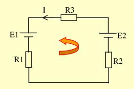
例: $R_1$ = $1\Omega$  ,  $R_2$ = $2\Omega$  ,  $R_3$ = $3\Omega$  , E3=3V ,  $I_3$ =3A ,  $\bar{\chi}I_1$ 、 $I_2$ 与两电源的功率。
