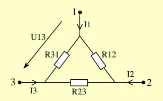
$$R_{12} = \frac{R_1 R_2 + R_2 R_3 + R_1 R_3}{R_3} \qquad R_{23} = \frac{R_1 R_2 + R_2 R_3 + R_1 R_3}{R_1} \qquad R_{31} = \frac{R_1 R_2 + R_2 R_3 + R_1 R_3}{R_2}$$
