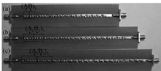
图 3 一维光子晶体 (AB)_8 (a)、 (A_2B_2)_5 和 (A_3B_3)_4 的照片 Fig. 3 Photographs of the fabricated photonic crystals (AB)_8 , (A_2B_2)_5 and (A_3B_3)_4 respectively
