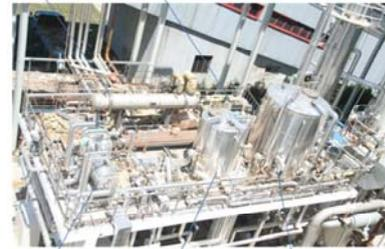
胺回收加热器 洗涤液储槽 溶液储槽
