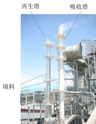
图 3 脱碳系统吸收塔和再生塔
