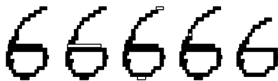
(a) 压缩前 (b) 原则① (c) 原则② (d) 原则③ (e) 压缩后 图 1 降维过程
