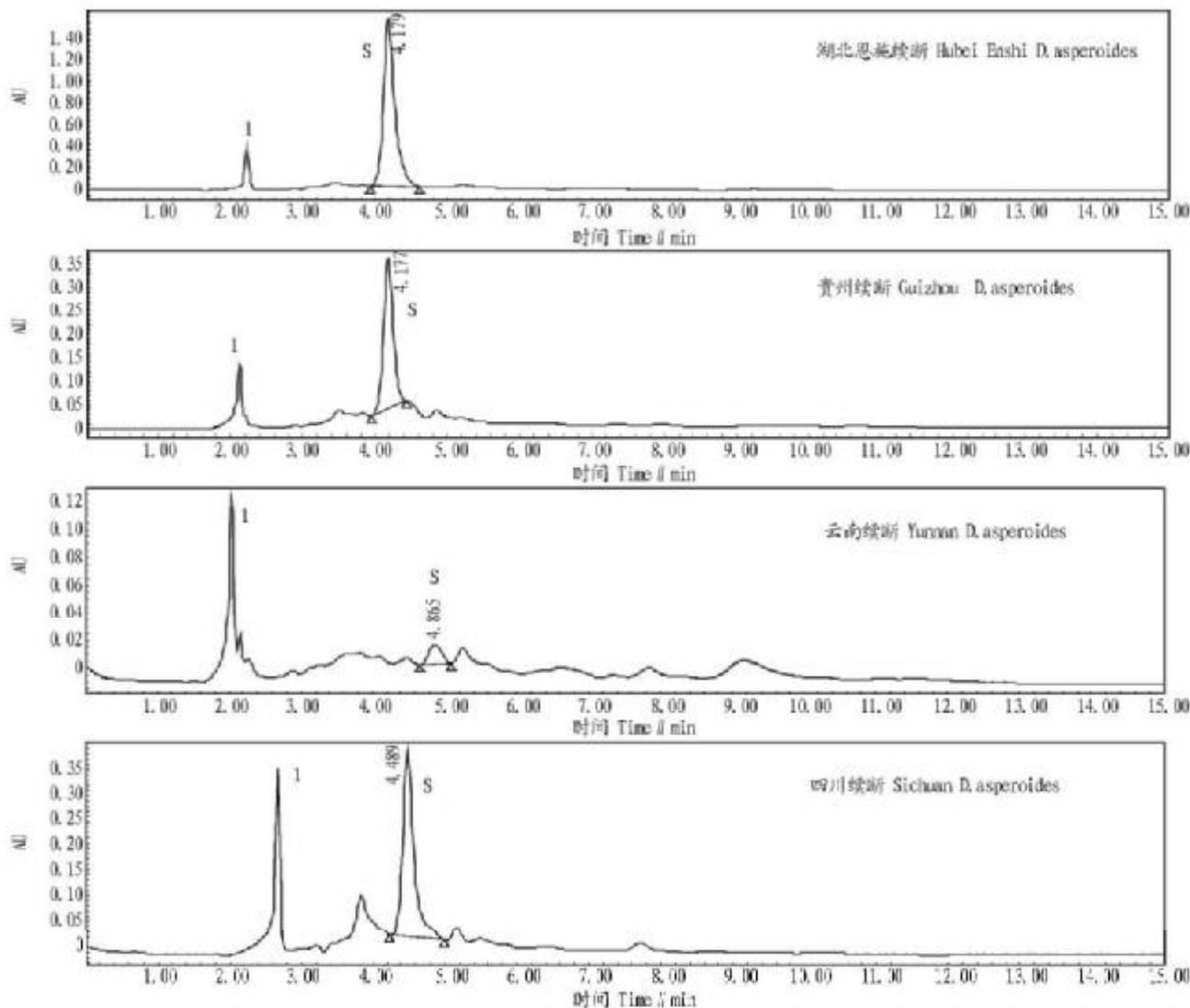
续断原料指纹图谱的判定标准为:续断原料样品指纹图谱应出现 2 个共有峰,其相对保留时间分别为 0.50(1)、1.00(s),其差值不得超过  $\pm 10\%$ ;非共有峰的总面积不得大于总峰面积的 5%。
