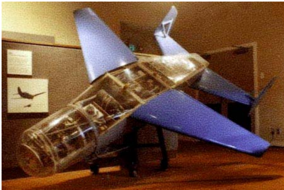
"蝙蝠"导弹内部结构示意图 [资料图片]
