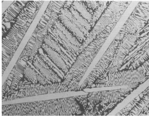
图 7.17 过共晶白口铸铁的室温平衡组织 100×
