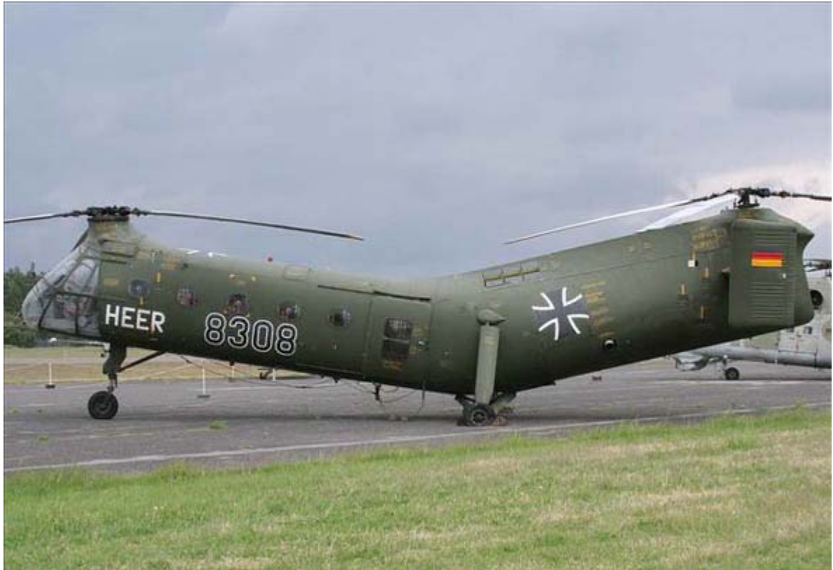
西德空军装备的纵列双悬翼式运输直升机 CH-21 [资料图片]
