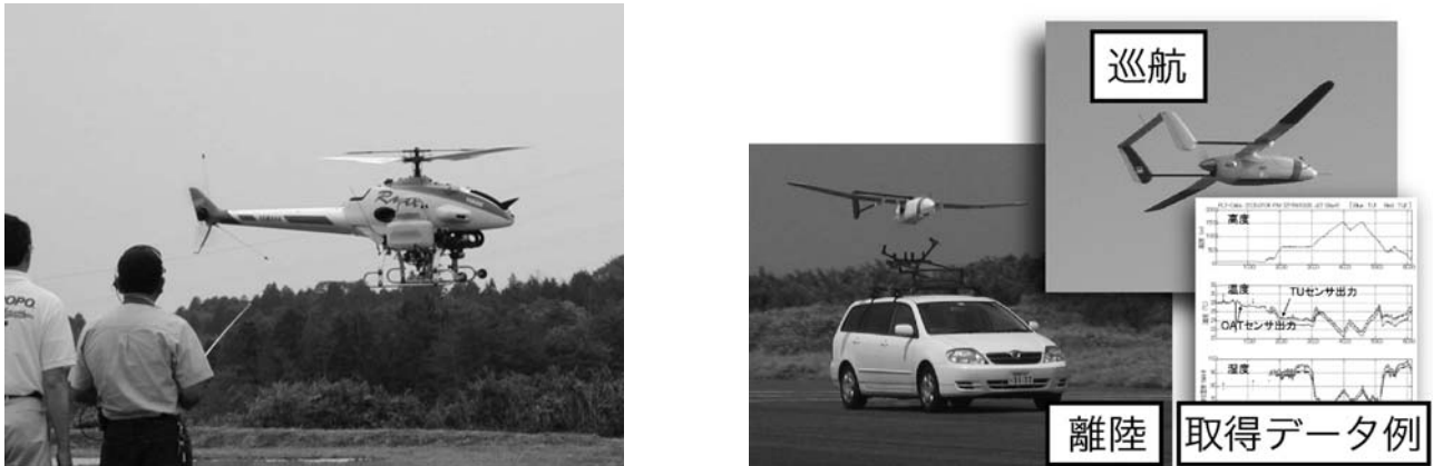
(a) ヤマハ発動機 RMAX による農薬散布
