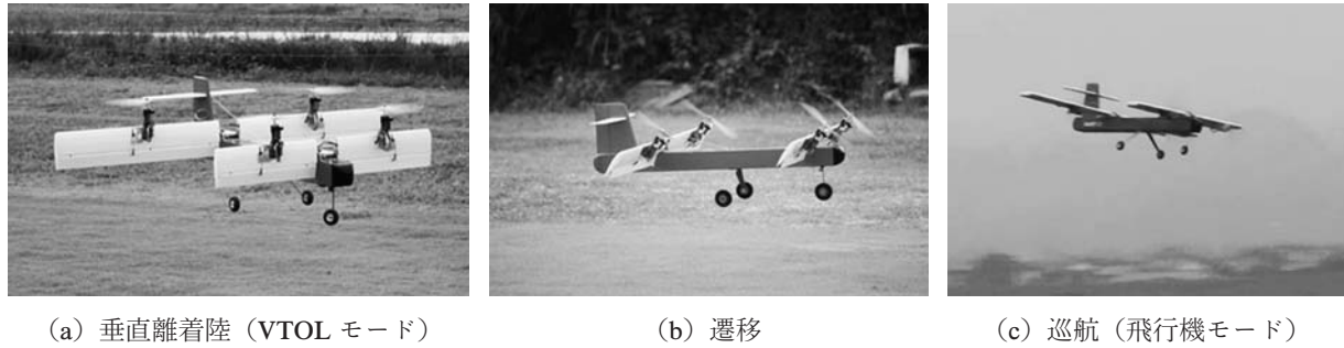
Fig. 4 4発ティルト翼 VTOL 小型無人実証機 (完全遷移飛行実証)
