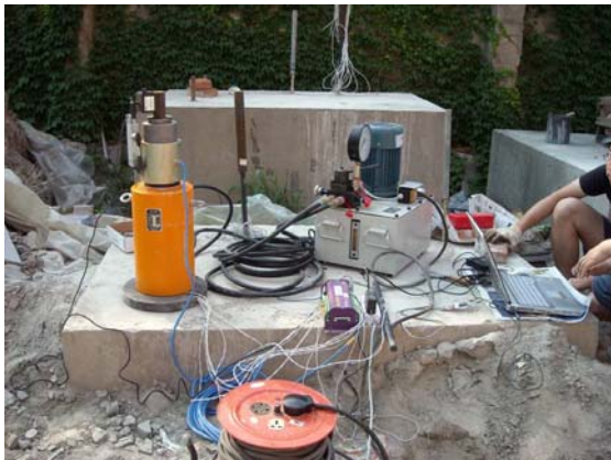
图 2 GFRP 锚杆拉拔试验设备
