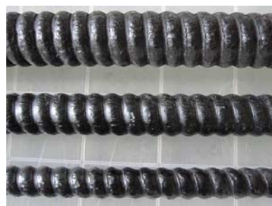
图 1 全螺纹 GFRP 锚杆表面形态
