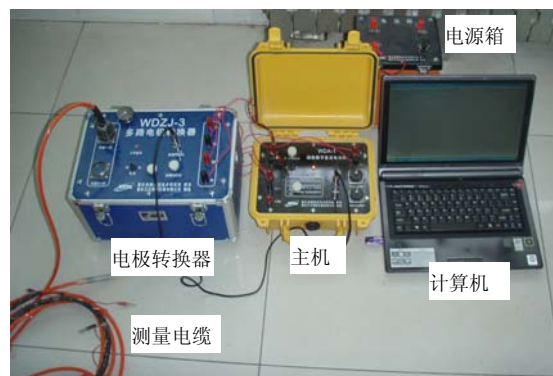
图 1 电阻率层析成像实时监测系统
